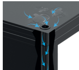
Wassersammelsystem auf dem Dach
